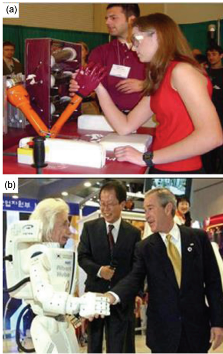
图3 (网络版彩图)基于介电弹性体的人工肌肉手臂 [13] (a)和面部表情的驱动 [8] (b)
