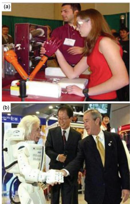
图3 (网络版彩图)基于介电弹性体的人工肌肉手臂<sup>[13]</sup>(a)和面部表情的驱动<sup>[8]</sup>(b)
