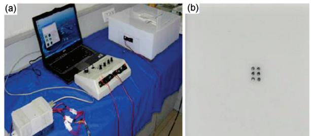
图8 (网络版彩图)基于介电弹性体的和盲文显示器<sup>[14]</sup>
