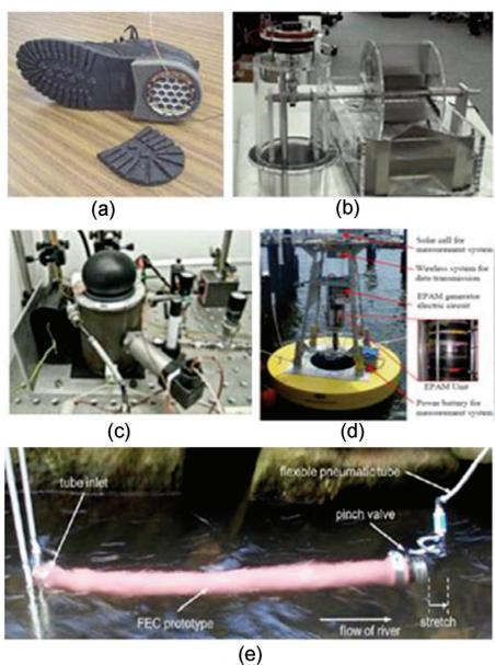
图 10 (网络版彩图)基于介电弹性体的能量收集器<sup>[9,26,31-34]</sup>
