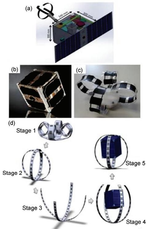
图7 (网络版彩图)卷曲多节式可展开夹持器<sup>[30]</sup>
