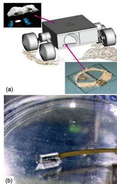
图5 (网络版彩图)基于电活性聚合物材料的智能除尘刷<sup>[15]</sup>
