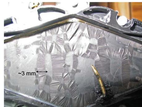
图 12 (网络版彩图)介电弹性体的机电不稳定<sup>[44,50]</sup>
