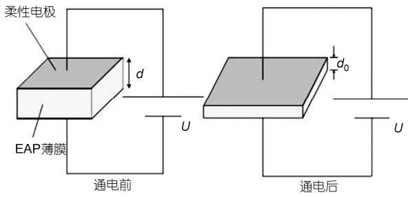
图 1 电压驱动介电弹性体的原理图<sup>[2]</sup>
