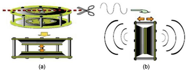
图9 (网络版彩图)介电弹性体扬声器<sup>[26]</sup>
