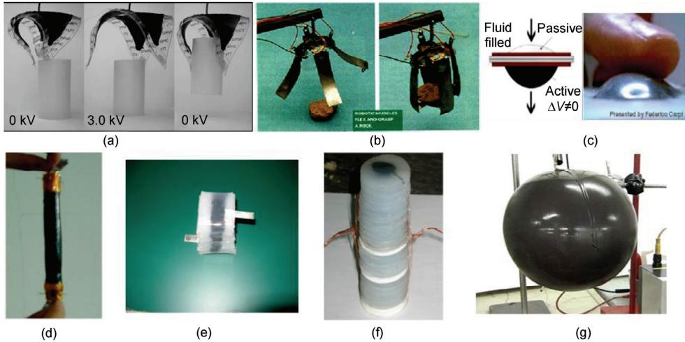
图 2 (网络版彩图)典型的 EAP 驱动器<sup>[7,10-12,25,26,28]</sup>
