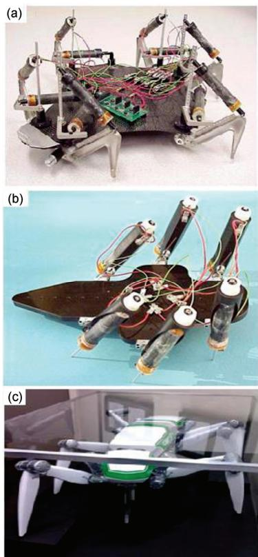
图4 (网络版彩图)介电弹性体仿生机器人<sup>[8,18]</sup>
