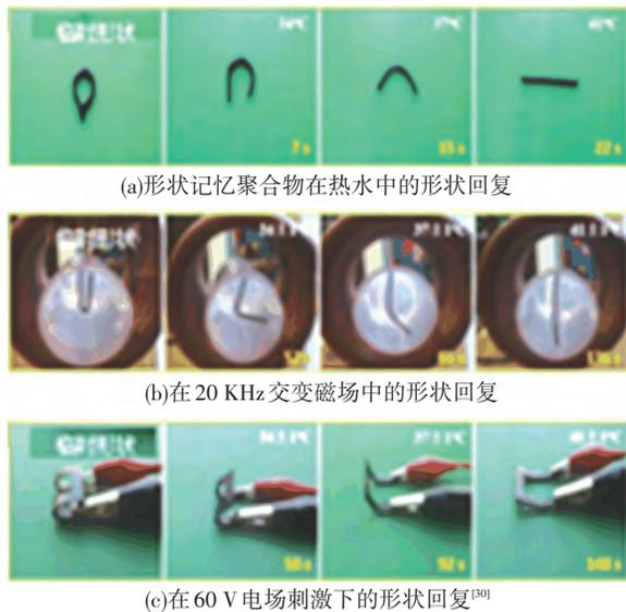
图 8 形状记忆聚合物感应不同刺激的回复过程
