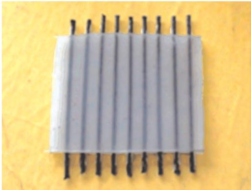
图 26 基于形状记忆聚合物复合材料的无缝蒙皮<sup>[47]</sup>
