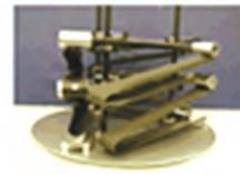
(b) 三纵梁桁架结构
