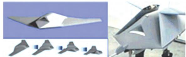
图 24 可变形飞行器的折叠机翼<sup>[45]</sup>
