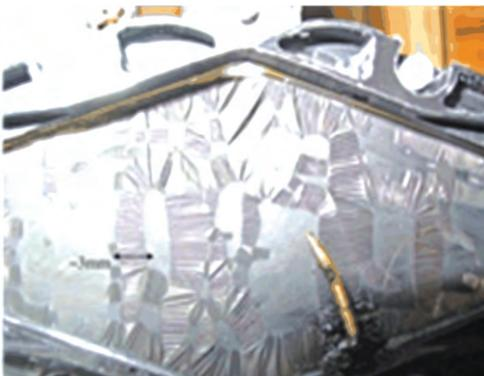
图34 介电弹性体的机电不稳定<sup>[53,88]</sup>
