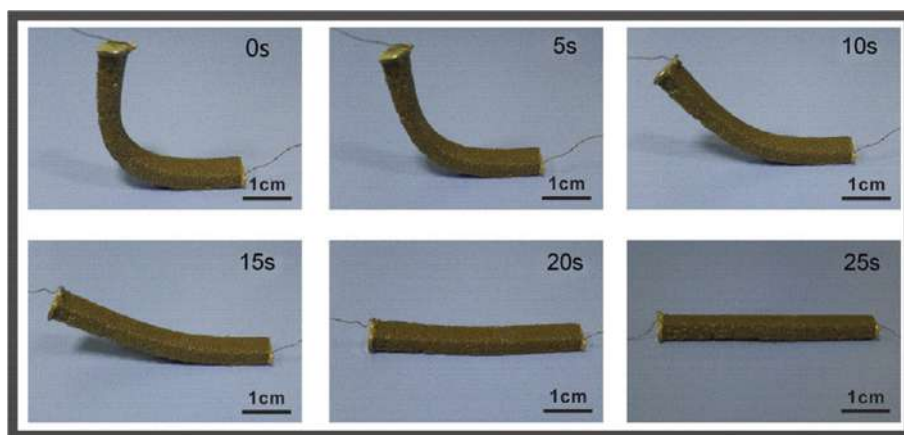
图5 (网络版彩图)3D AgNW填充SMPC在3 V超低电压下的形状回复过程 [68]
