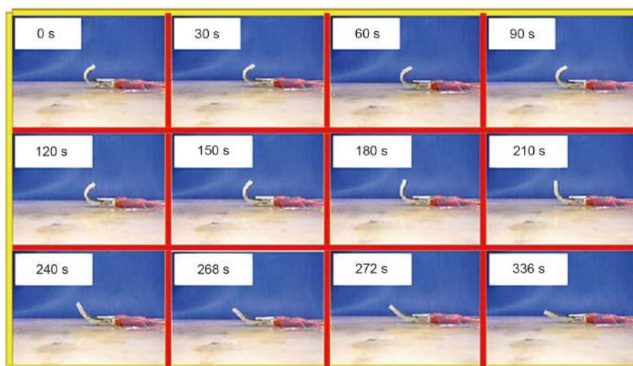
图10 (网络版彩图)MWCNT纳米纸填充SMPC的电驱动形状回复过程 [75]
