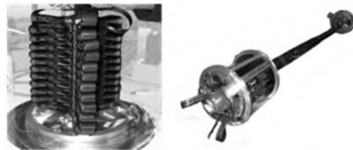
图7 三翼梁式可展开桁架的折叠状态和展开状态<sup>[18]</sup>
