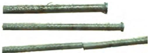
图21 基于形状记忆聚合物复合材料的释放机构解锁过程<sup>[29]</sup>
